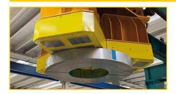
Soluzioni per il sollevamento e la movimentazione di coils compatti sia ad asse orizzontale che verticale di qualsiasi peso e dimensione.
