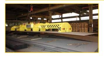
Traverse elettropermanenti, fisse e telescopiche, in grado di movimentare lamiere di tutte le dimensioni, sia di piccolo che di grande spessore.
