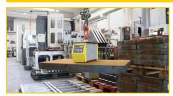
Sollevatori a batteria per il sollevamento e la movimentazione di carichi ferrosi di diverse forme e dimensioni.
