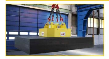
Sollevatori elettropermanenti per la movimentazione di bramme e blocchi fucinati o forgiati con elevati traferri.
