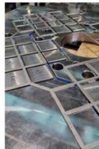
Piastra per l'ancoraggio magnetico sulle presse per stampaggio a iniezione.
