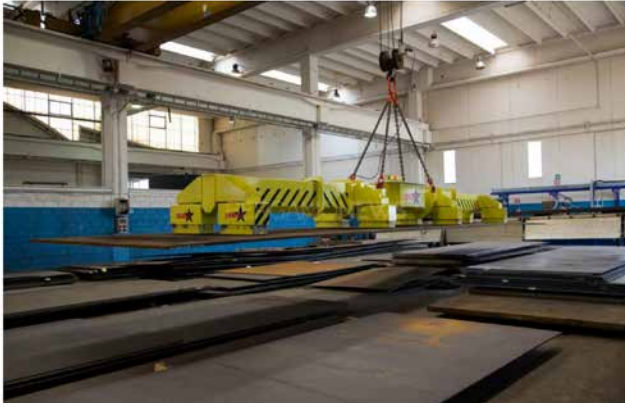
Un sistema magnetico elettropermanente applicato al sollevamento
