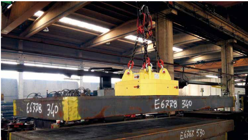
SEP, moduli elettropermanenti ideati per la movimentazione di lamieroni, bramme e blocchi fucinati o forgiati con elevati traferri
