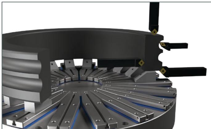
Grazie all'assenza delle parti ingombranti presenti nei sistemi di bloccaggio convenzionali, il sistema magnetico consente ampio accesso alle zone lavorabili del pezzo.
